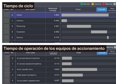
Visualice los tiempos de ciclo y controle el tiempo de operación de los equipos rápidamente con sólo configurar unos sencillos ajustes de los dispositivos.
