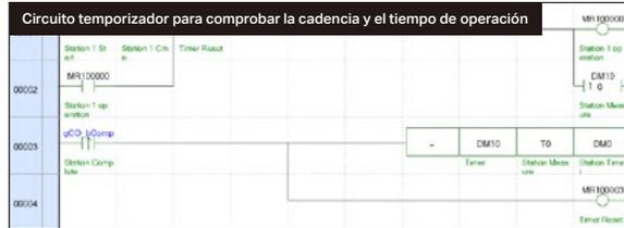
Establezca un circuito temporizador para comprobar el tiempo de ciclo y el tiempo de operación.
